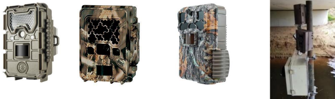
Figuur B1.1. v.l.n.r. Bushnell Trophy Cam HD, Reconyx Hyperfire HC600, Browning recon force elite HP4 en bevestiging van twee wildcamera's (boven een Batcorder 7.1.) op een verzwaarde stalen paal onder KW 12
